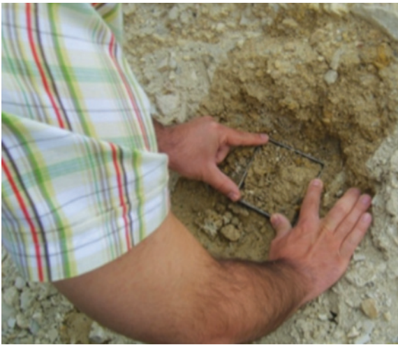
Şekil 5. Suyla ıslatılmış pasadan örselenmemiş örnek alımı.
